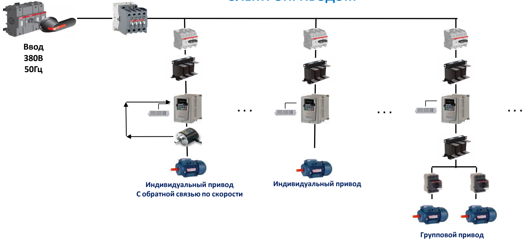
Функциональная схема 1 (с применением тормозных резисторов)
