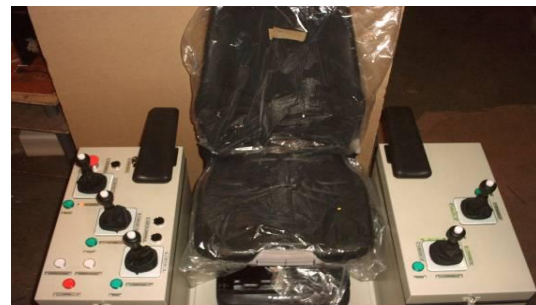
Пульт управления оператора
