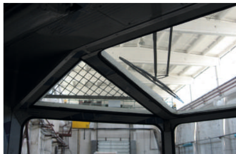
Остекление кабины бурильщика
